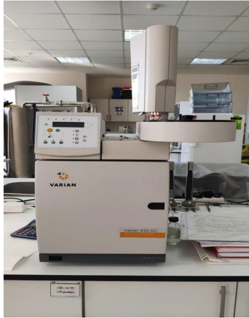
Şekil 3.81. Uçucu organik asit analizlerinin yapılmasında kullanılan Varian 430-GC gaz kromatografi cihazı
