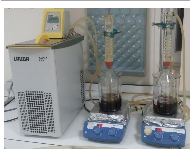
Şekil 3.12. Alkali H 2 O 2 ön arıtma denemelerinde kullanılan deney düzeneği
