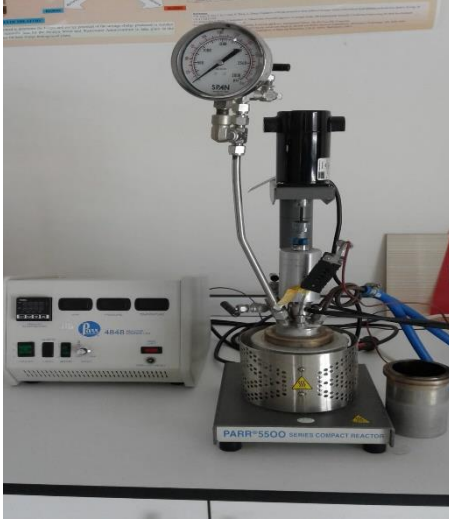
Şekil 3.41. Yüksek basınç ve sıcaklık ön arıtma reaktör sistemi
