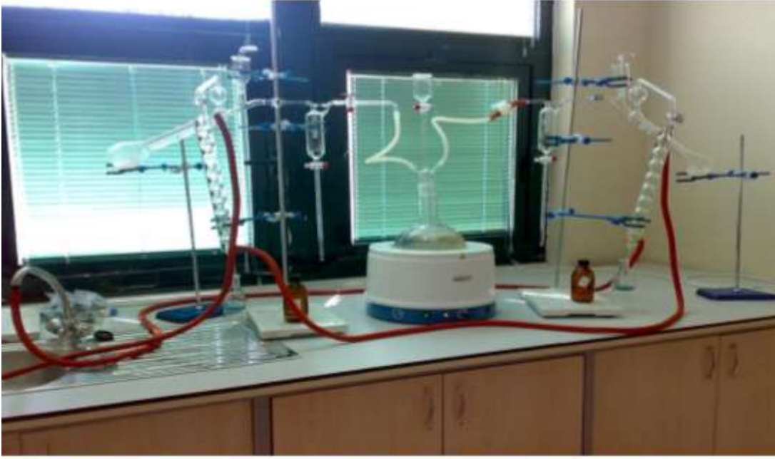
Şekil 3. Mikro destilasyon cihazında toprak örneklerinin destilasyonu
