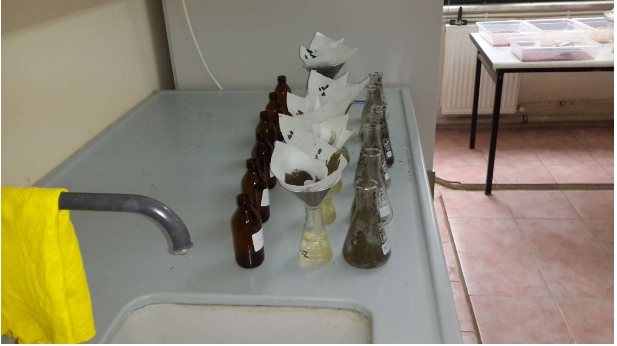
Şekil 4. Mikrobiyal biyokütle tayinin için ekstraktların hazırlanması
