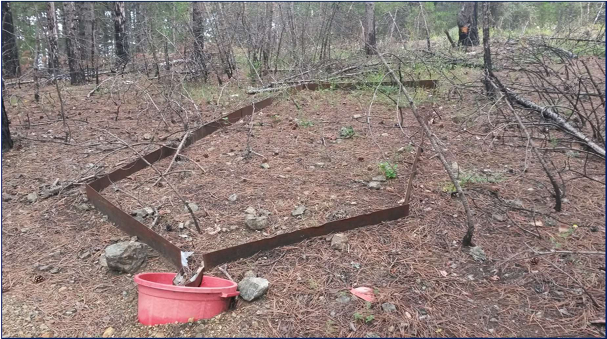
Şekil 5. Erozyon ölçümünde kullanılan 5 x 2 m ebadındaki yüzey akış parseli
