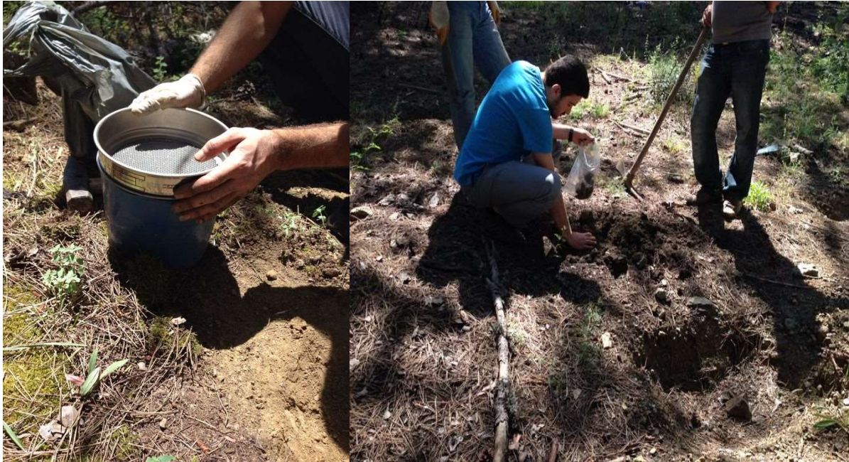
Şekil 2. Deneme alanlarında yakma sonrası dönemlerde toprak örneği alımı
