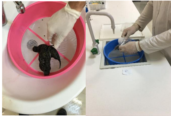
Şekil 28 0,5-0,8 mm Eleklerde Yıkama İşlemi
