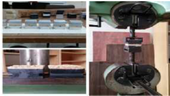
Şekil 3. Yüzeye dik çekme deney düzeneği
