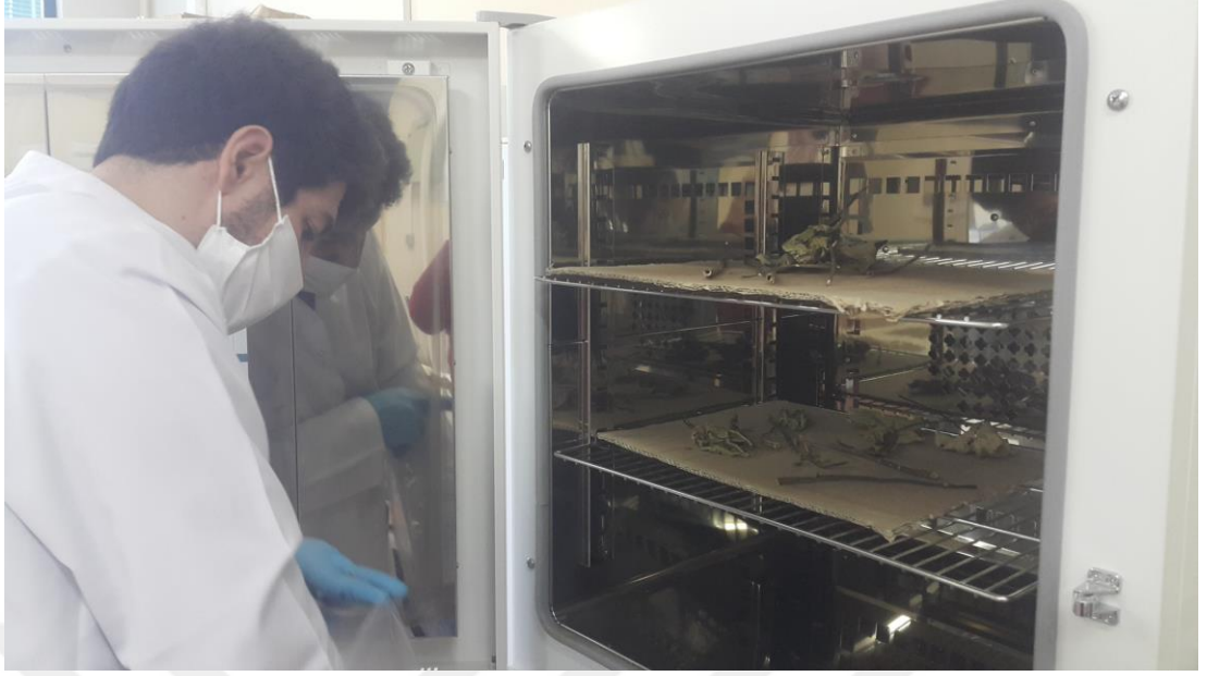
Şekil 26. Bitki örneklerinin etüvde kurutulması.
