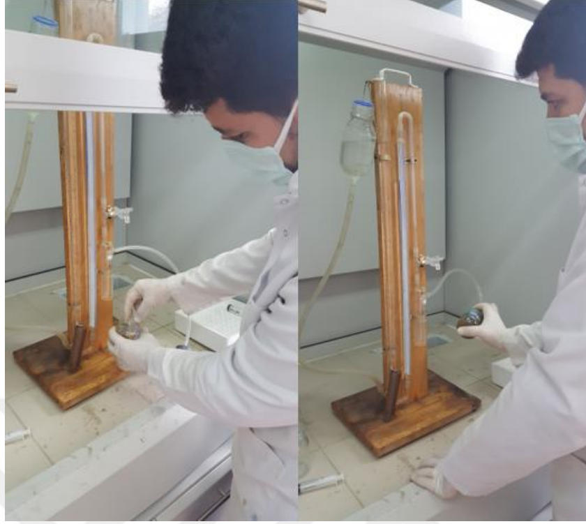
Şekil 16. Toprak örneklerinin kireç analizi
