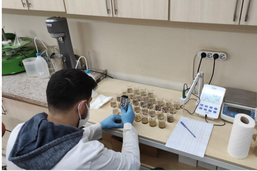
Şekil 14. Toprak örneklerinin elektriksel iletkenliklerinin ölçülmesi
