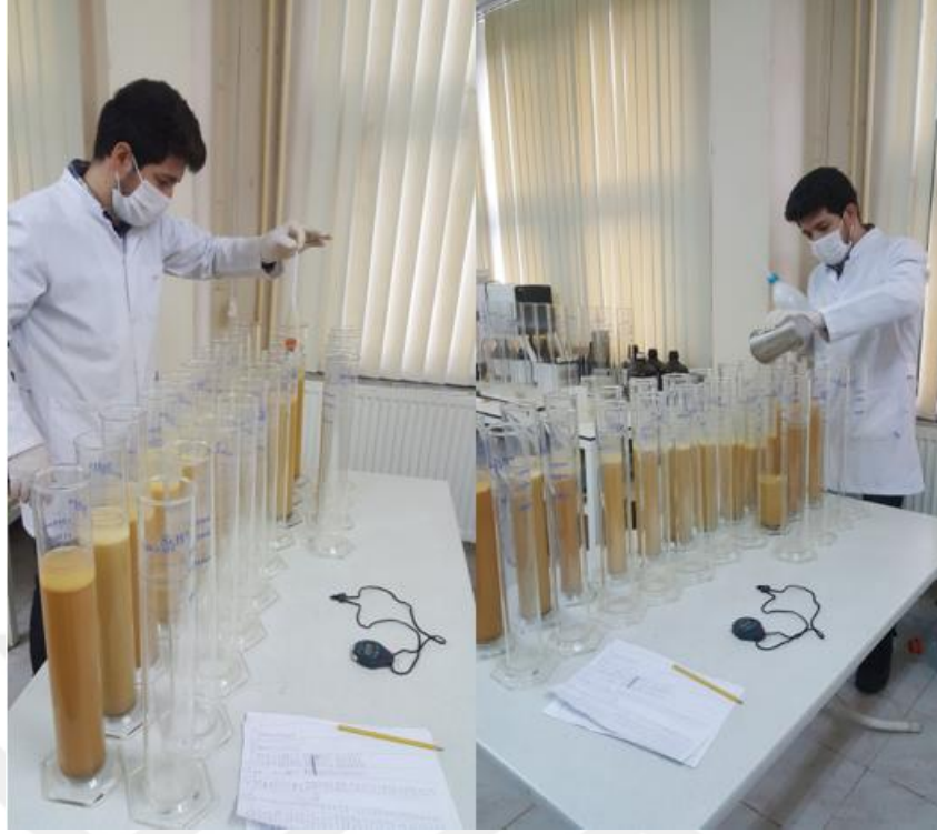
Şekil 12. Toprak örneklerinde tekstür analizinin yapılması
