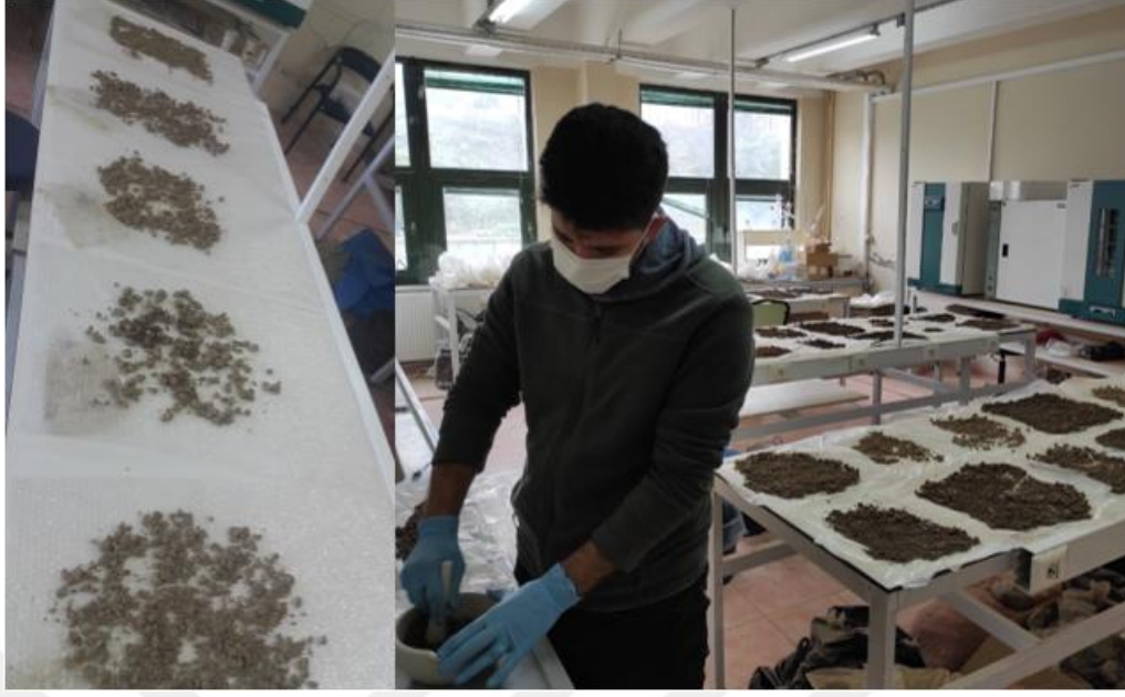
Şekil 11. Toprak örneklerinin kurutulup, analizlere hazır hale getirilmesi
