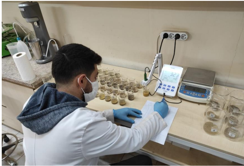
Şekil 13. Toprak örneklerinin pH analizi
