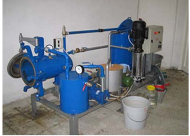
Şekil 8. Emprenye düzeneği (Baysal ve ark., 2004).
