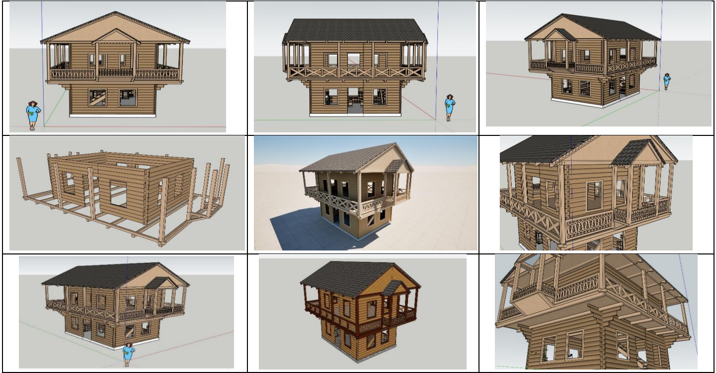
Şekil 11. Ahşap Şavşat evinin Sketchup programı ile modellenmesi
